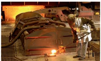
Unsere beiden Hochöfen können bis zu 10.000 Tonnen Roheisen täglich erschmelzen. Das Roheisen wird im Stahlwerk durch das Linz-Donawitz-Verfahren zum Rohstahl weiterverarbeitet und in der Stranggießanlage zu Brammen gegossen.
