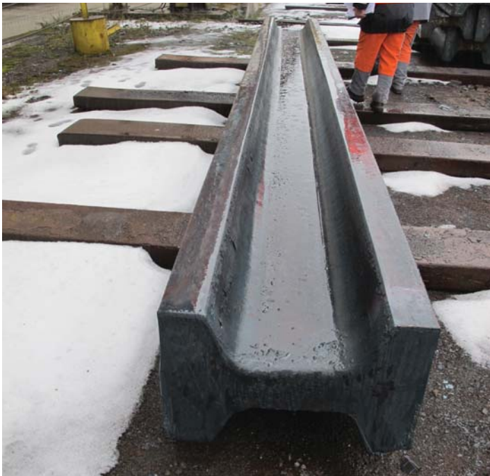
Abb. 8 AMLoCor Beam Blank zum Walzen von Spundbohlen
