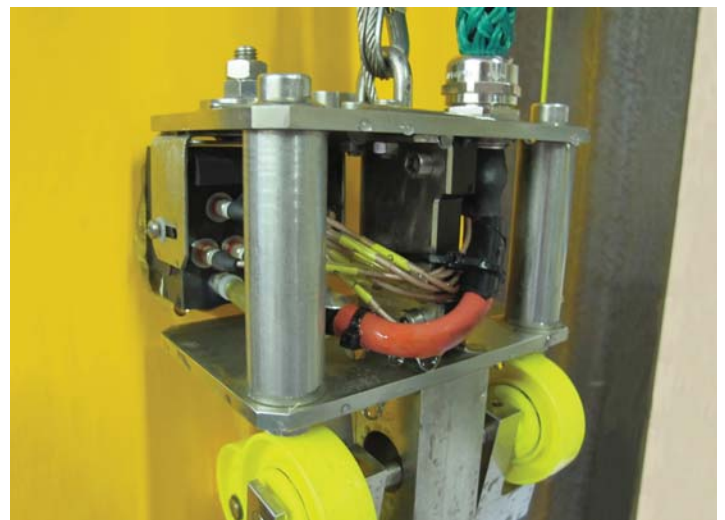
Abb. 7 Prototyp des US Ultraschall-Messgeräts
