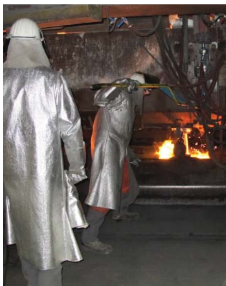
Abb. 2 Stranggießen von AMLoCor
