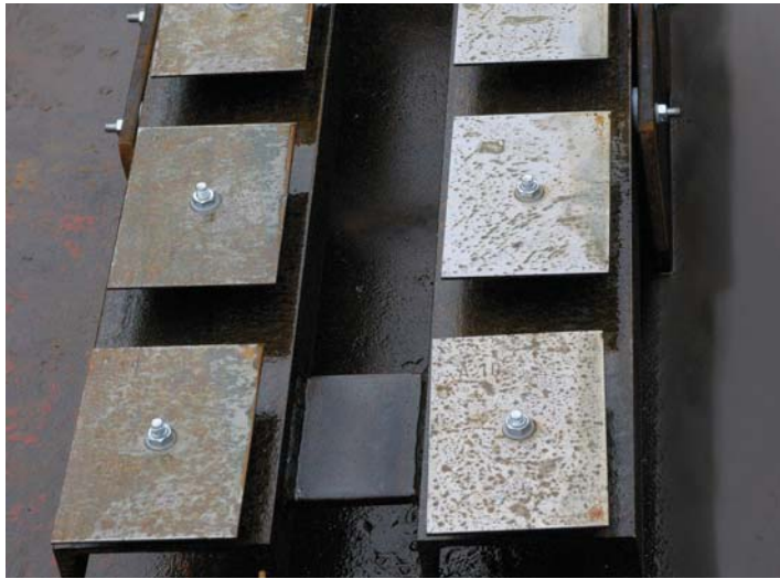
Abb. 6 Probekörper in einem großen nordeuropäischen Hafen
